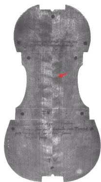
横板の高さを円弧で描いたストラディヴァリの内枠
